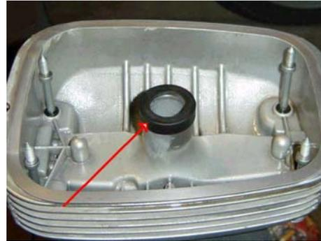
**36** Rimontare accuratamente il coperchio delle valvole e avvitare leggermente le 4 viti.
