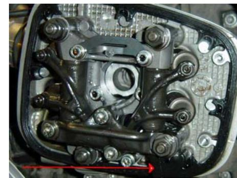
**35** Posizionare la guarnizione centrale sul coperchio delle valvole ruotata di 120°.
