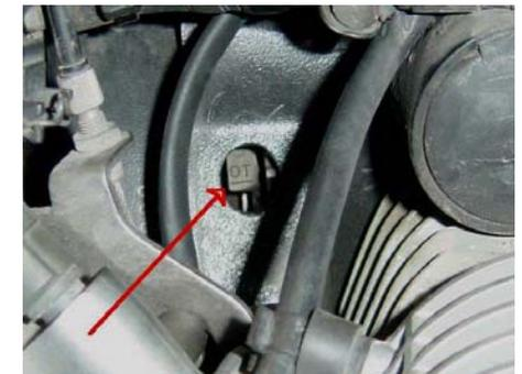
**16** Centrare la linea (sotto il simbolo OT) posizionandola al centro della finestrella. *Nella stessa posizione, la freccia sull'ingranaggio della catena della camma sarà puntata in fuori in orizzontale (guardare sotto le valvole della testata).*
