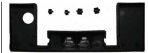
Il porta cilindretto è attaccato al blocco con due rivetti.
