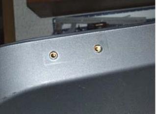
(2) Osservando l'interno della borsa senza coperchio si noterà che essa è costituita da 2 gusci che, uniti tra loro, celano il meccanismo di chiusura ed aggancio alla moto con i vari leveraggi e serratura. Essi sono uniti da una serie di viti torx, che bisogna cominciare a svitare una ad una segnando con del nastro da carrozziere la loro posizione.
