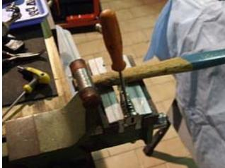
Smontando le linguette (solo quelle che sporgono, le altre vanno già bene così come sono) si noterà che esse sono diverse le une dalle altre, e se si osservano bene si vedrà che sono anche numerate (1,3,2,.....) a seconda del tipo. Bisogna invertire la loro posizione fino a trovare la combinazione giusta, quella cioè che a chiave inserita le farà rientrare tutte.
