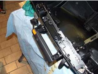
(4) Inizia a questo punto la parte più delicata, che consiste nello smontaggio del blocco serratura.
