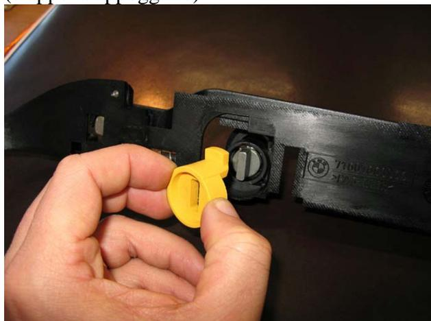
3. agire sulla linguetta di ritenuta del cilindretto con un piccolo cacciavite, DOPO AVER INSERITO LA CHIAVE NELLA SERRATURA
