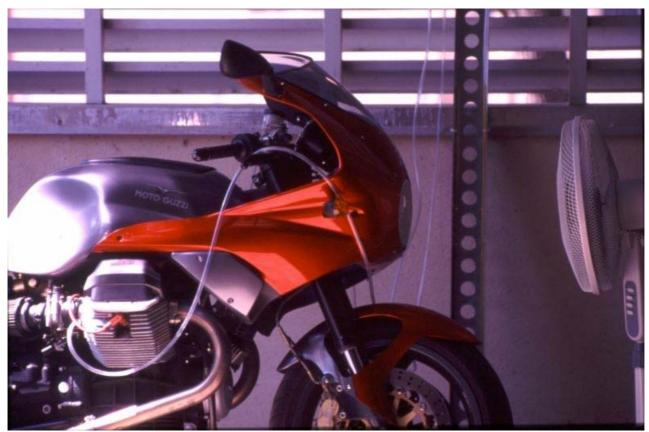
Accendete ora il ventilatore e il motore. Portate il motore a 3000 giri/minuto e controllate che il livello dell'olio nei 2 rami della U sia alla stessa altezza.
