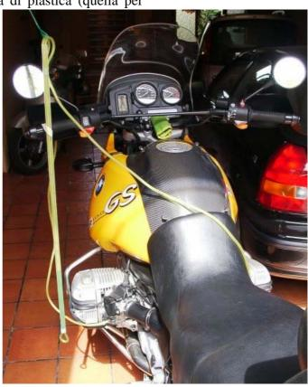
Conclusioni: funziona, sicuramente meglio di qualsiasi vacuometro elettrico hobbistico. Non vi sono tarature dello strumento da fare e il risultato è sicuro. A mio avviso si può usare un olio meno fluido rispetto a quello che ho usato io o al gasolio, altrimenti le pulsazioni al minimo sono parecchie e causano bollicine.
