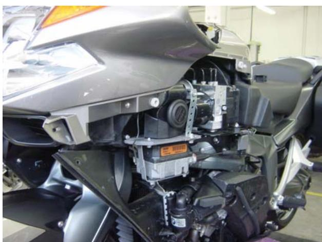
Abbiamo collegato il tutto alla batteria costruendo un cablaggio con porta fusibile.
