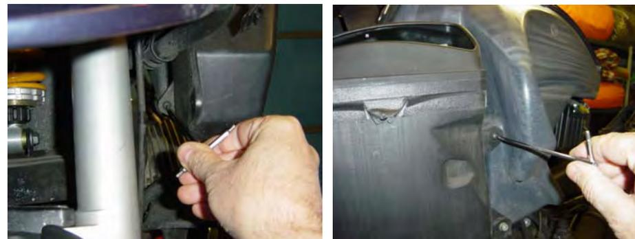
**212** Montare il condotto di presa d'aria (2 viti).
