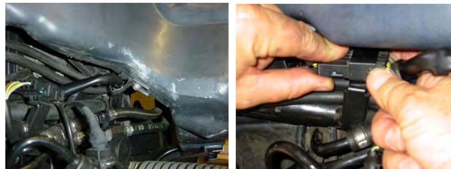
**10** Scollegare il connettore elettrico della pompa carburante.
