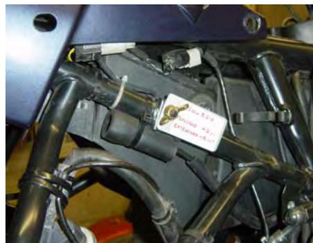
**77** Estrarre il serbatoio posteriore del liquido dei freni dal grosso fermaglio, e lasciarlo penzolare.
