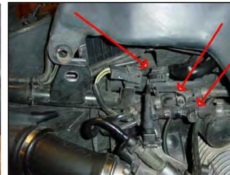
**207** Collegare il connettore elettrico della pompa carburante.
