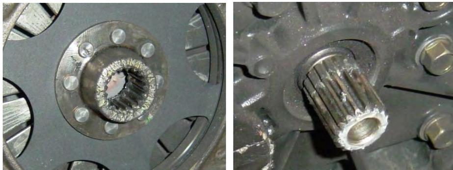
Le due foto seguenti mostrano come potrebbe apparire l'albero millerighe del cambio e il relativo mozzo della frizione al momento dello smontaggio dopo 40.000 km: sono ambedue già secchi e arrugginiti per mancanza di lubrificazione (l'albero a sinistra è già stato pulito).
