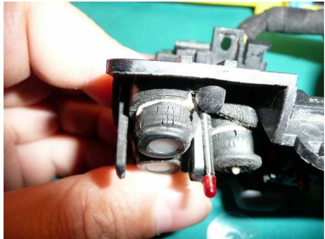
Ogni pulsantino ha i fili del cablaggio saldati ai reofori dello stesso, e resinati.
