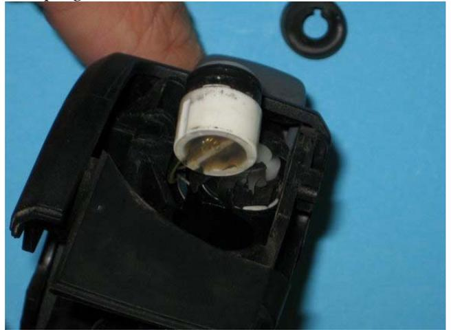
Il bottone bianco ha due componenti di plastica: il copribottone (o cappuccio) e il cursore con la molla elicoidale. Notare la linguetta di plastica all'interno del cursore, quello al centro (foto a destra). Con uno strumento rotante ho limato la piccola protuberanza sulla sommità della linguetta di plastica.
