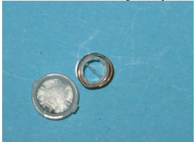
Particolare dell'ossido di rame e delle due alette di rame all'interno del bottone (sono i contatti). Pulizia con carta vetro (okkio le lamelle sono sottilissime).
