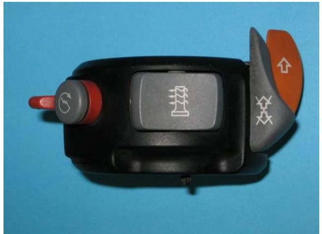
Con un piccolo cacciavite da orologiaio fare leva sotto il tasto del ripristino frecce.
