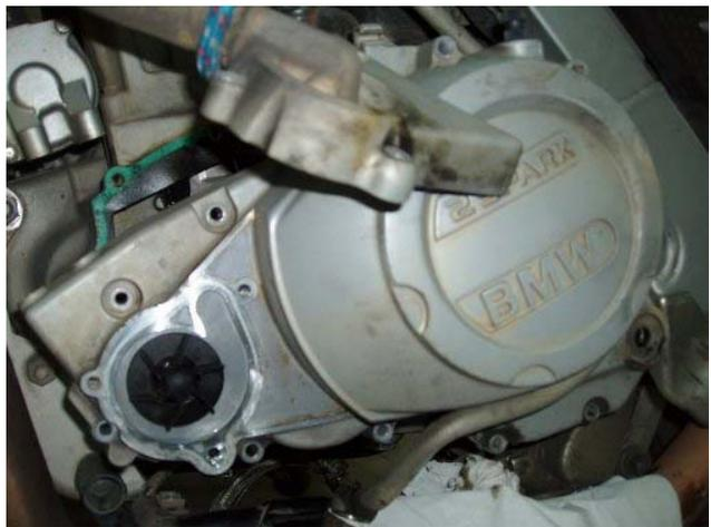
A questo punto (sulla sinistra nella foto) si vede l'ingranaggio di comando della pompa solidale alla girante per via dell'alberino.
