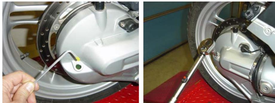
**40** Chiudere il tappo di rifornimento con un nuovo anello di tenuta di rame Ø 14 - 19 mm, serrando alla coppia di 23 Nm.
