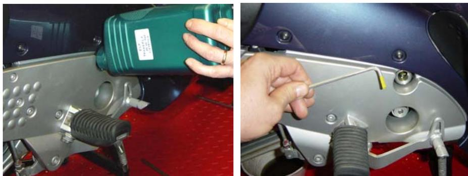
**32** Chiudere il tappo di rifornimento con un nuovo anello di tenuta di rame Ø 18 - 22 mm, serrando alla coppia di 30 Nm.
