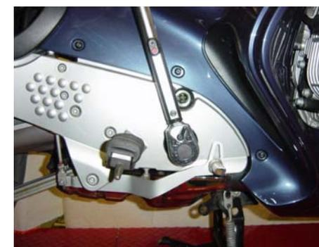
**31** Versare l'olio **molto lentamente** fino a raggiungere il livello, cioè fino al bordo inferiore del foro di riempimento (meglio 5 mm di meno).
