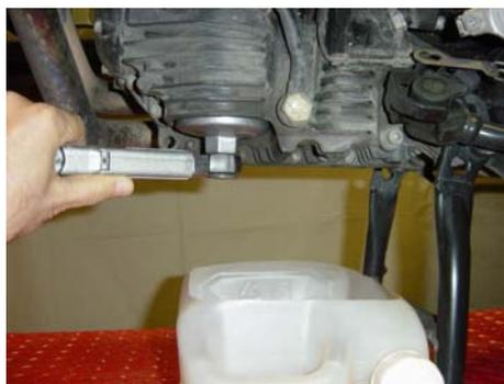
*Per avvitare il filtro senza chiave dinamometrica bisognerebbe avvitare fino a quando la guarnizione entra in contatto con la sede sul motore, quindi avvitare ancora per 3/4 di giro. E' un'operazione sconsigliabile, perché è difficile capire quando la guarnizione entra in contatto con la sua sede nel motore.*
