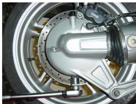
**39** Versare l'olio **molto lentamente** fino a raggiungere il livello, cioè fino al bordo inferiore del foro di riempimento (meglio 5 mm di meno).
