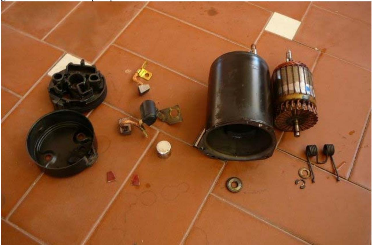
Pulito il fondello con i magneti, c'era molta limatura che si mischiava con il grasso. Lubrificato l'asse dell'avvolgimento con poco grasso. Richiuso il motorino.
