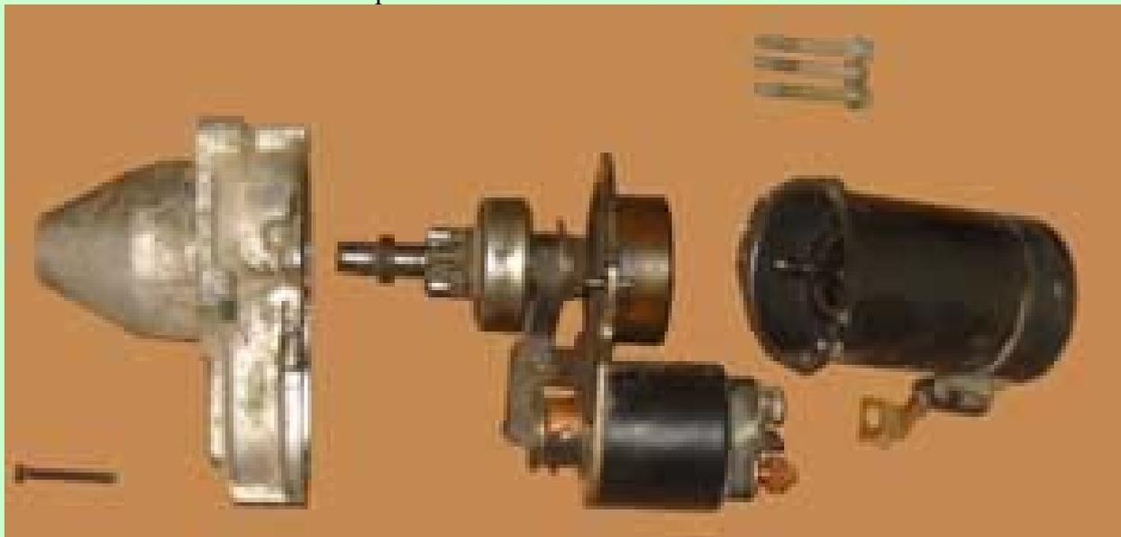
Se volete solo far tacere lo stridere del motorino non è necessario continuare a smontare oltre, basta la sola pulizia delle scanalature curve tra il pignone e l'alberino del motorino, e la pulizia del nucleo della bobina.
