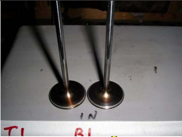
Valvole d'aspirazione destra 😊 pulite e in buono stato.
