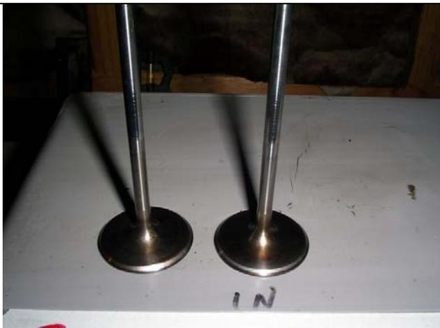
Valvole d'aspirazione sinistra 😊 pulite e in buono stato.
