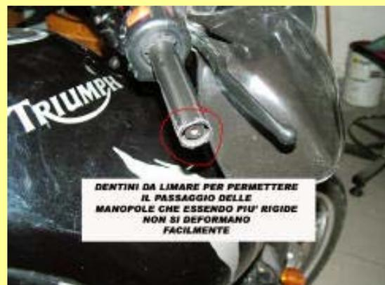
Aiutatevi con acqua e sapone per inserire la manopola, sempre reggendo il comando con le pinze. Solo nella parte finale, dove non è possibile reggere il comando con le pinze, forzate leggermente nel senso opposto della rotazione del gas per fare l'ultimo cm e trovare la posizione appropriata.
