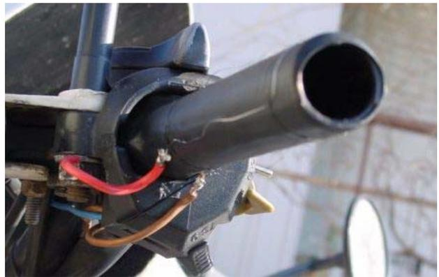
(8) Infilare sopra la resistenza il secondo strato di Panduit e ripetere l'operazione di termorestringimento.
