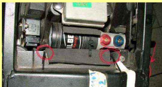
Dopo aver dotato il filo di morsetto femmina collegatelo ad un morsetto del fusibile.
