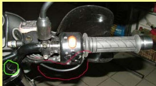
Mettete una sola fascetta per indirizzare il cavo (verde) in modo che sia libero di ruotare e di tornare bene nella posizione iniziale.
