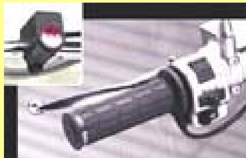
NB : Per collegare il kit all'impianto elettrico, e tenere l'impianto sotto chiave quadro, consigliamo l'uso del nostro Relè 12 Volts (cod. LP-4550.0).
