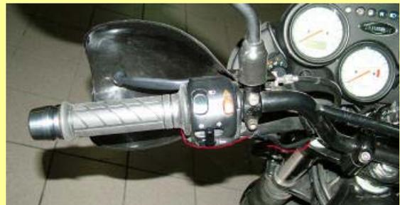
Manopola destra: prestare attenzione, sia per togliere che infilare la manopola è sempre bene tenere fermo il comando del gas con delle pinze oppure un pappagallo per non forzare troppo il comando.
