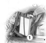
Montaggio della batteria · Ingrassare i poli della batteria
