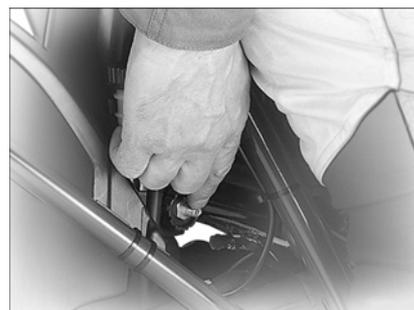
Esercitando pressione sulla punteria delle valvole scaricare l'aria dal Air Damping System e controllare il livello. Per innestare il perno della valvola è possibile utilizzare la punta del cappuccio coprivalvola.
