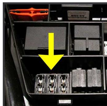
9) Procurarsi un **relais** da 12V – 30 A e uno **zoccolo** faston. Individuare esattamente i quattro terminali da utilizzare (due per la bobina, due per il carico).
