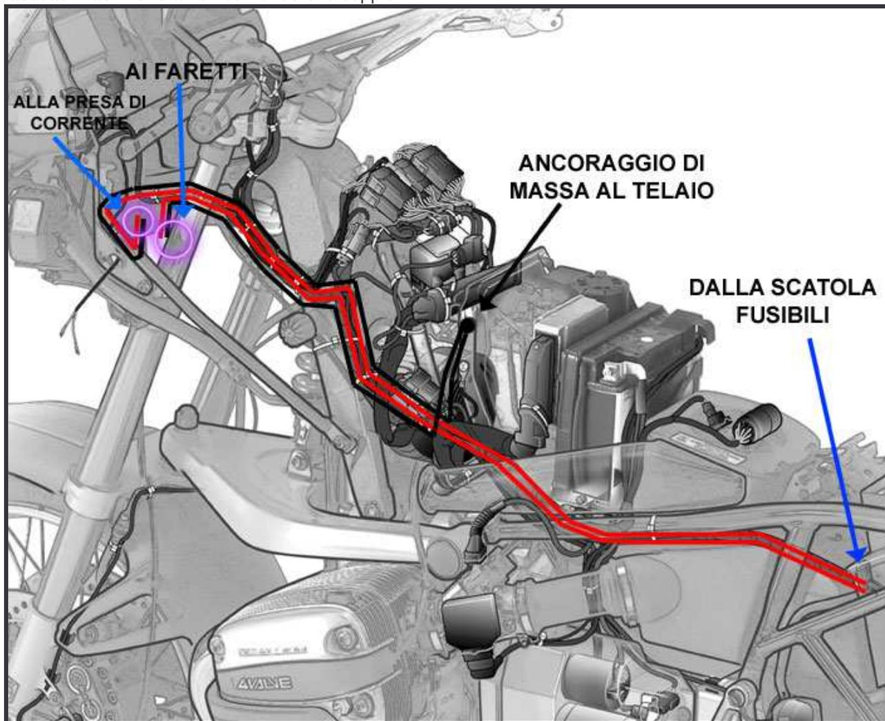
14) Forare il fianco sinistro del becco e avvitare una presa di corrente con sportellino a molla. Infilare nella coppia di cavi rosso-nera una pipetta in gomma. Cablare quindi le due estremità dei cavi con terminali faston e cappucci isolanti. Facendo attenzione a non invertire le polarità, connettere i faston alla presa. Infine spingere la pipetta verso l'alto, isolando in questo modo il tutto. Inserire nella scatola fusibili il fusibile A (da 5A) e provare se c'è tensione nella presa.
