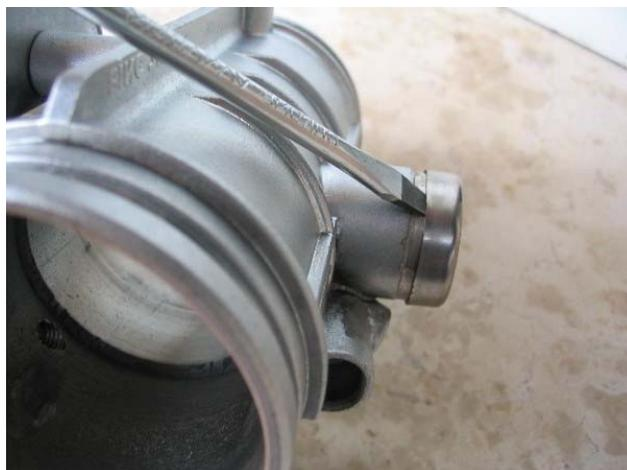
Estrazione delle boccole: la soluzione migliore è un maschio conico da 9x075 (e non da 8 come detto in precedenza), perchè nel caso le boccoline internamente non dovessero essere ovalizzate si dovrebbe penare troppo per filettarle, mentre il primo della serie da 9 è perfetto.
