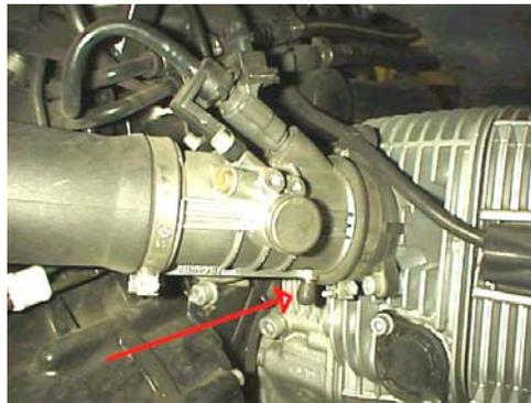
**Inizialmente** si effettuerà la regolazione dell'allineamento a regime di rotazione minimo (1100 rpm), agendo sulla vite di ricircolo aria destra.
