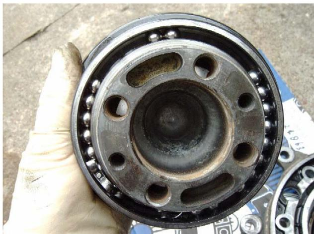
Nel frattempo che si sta armeggiando per l'estrazione del cuscinetto vecchio, è meglio mettere il nuovo cuscinetto sul tubo di scarico per riscaldarlo bene col motore acceso.
