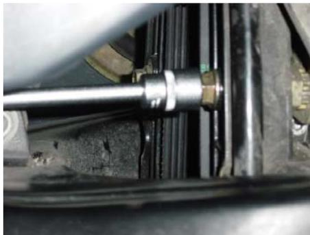
Girando il dado in senso orario, la vite di registro solleverà l'alternatore tramite la cremagliera.
