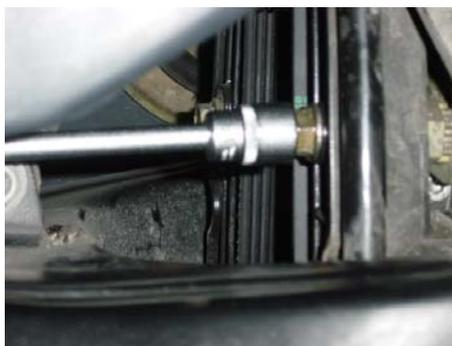
*Mantenere sempre caricata la vite di registro con chiave dinamometrica a 8 Nm, per non lasciare abbassare l'alternatore per proprio peso. La cinghia si allenterebbe troppo. Altrimenti l'operazione dovrà essere ripetuta un'altra volta dopo aver fatto girare la puleggia inferiore di 1 giro.*
