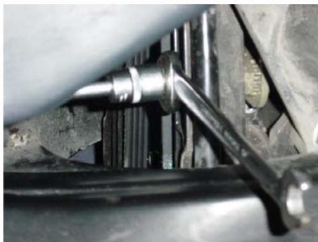
**15** Allentare le viti di fissaggio dell'alternatore (3, 4), mantenendo caricata la vite di registro con una chiave dinamometrica a 8 Nm.
