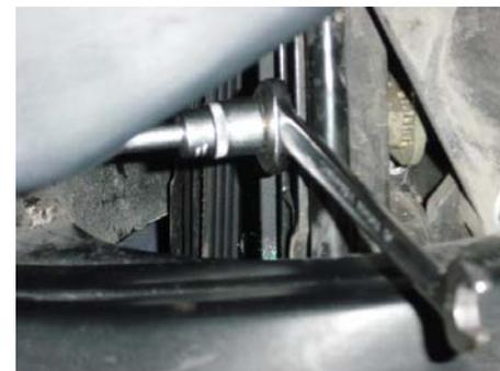
**13** Allentare le viti di fissaggio dell'alternatore (3, 4). (3, 4, D), fino a lasciar scendere l'alternatore in basso.
