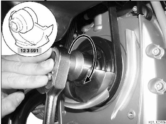
Serve solo per infilare la nuova cinghia nella puleggia inferiore, con l'alternatore allentato. Sullo sfondo c'è il motore sui cui dovrai mettere le mani fra qualche anno, il nuovo motore 1200 boxer.
