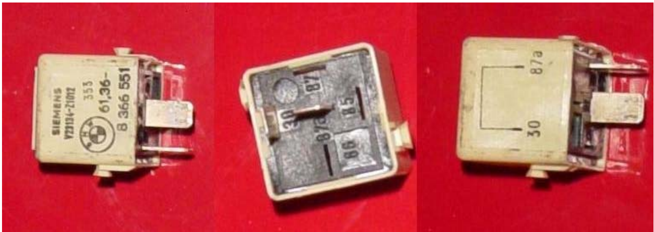
Questo nella foto è il vero spinotto 61 36 8 366 551 Beige con contatti 30 - 87a chiusi.
