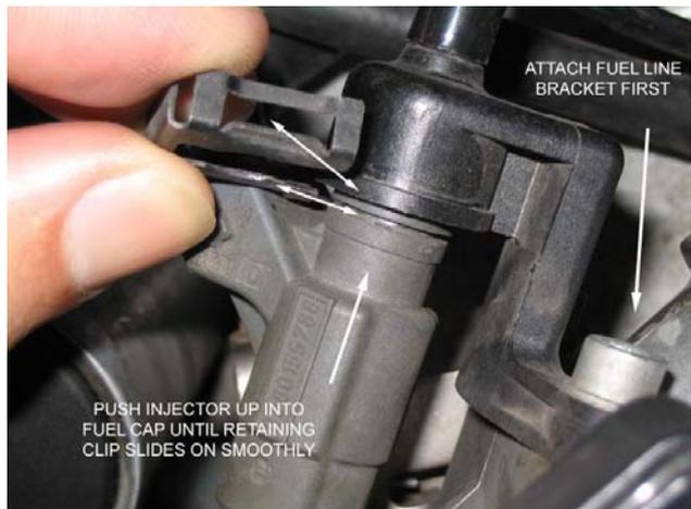
Ruotare l'iniettore in modo che la presa elettrica si trovi in alto, allineata sopra il fermaglio.
