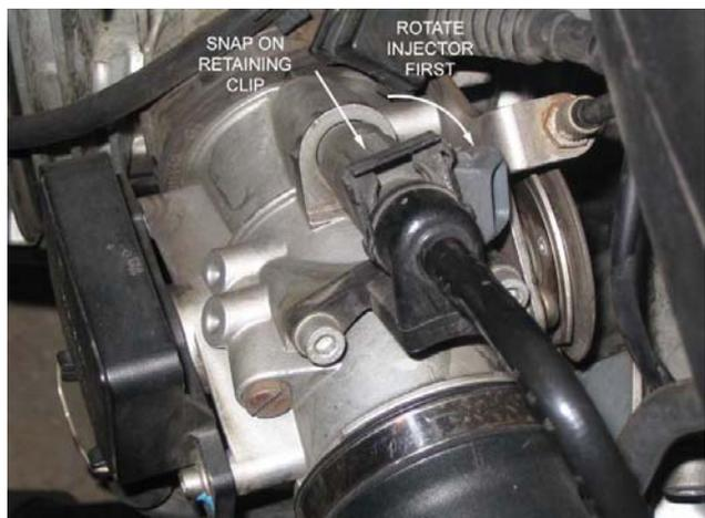
Se il fermaglio della benzina non entra facilmente, il problema è che l'iniettore non è completamente compenetrato nella scodellina del tubo benzina.
