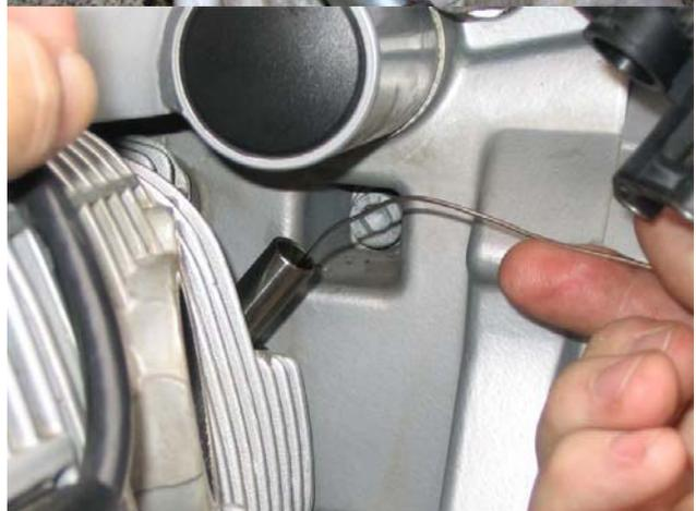
Prima di introdurre il corpo del tenditore nel foro, non dimenticare di mettere la nuova rondella di rame.
