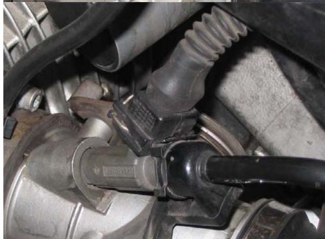
Tutto è orientato correttamente, il connettore elettrico blocca anche il fermaglio della benzina.
