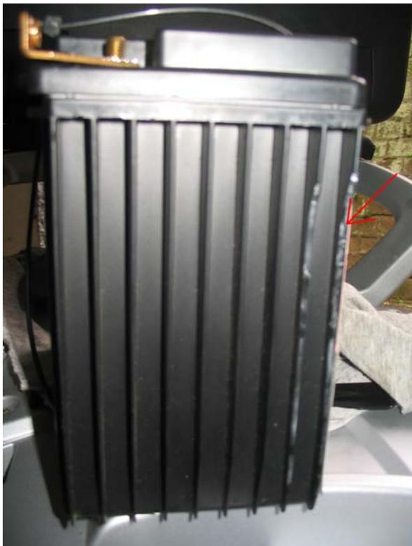
Risulterà anche utile limare i due spigolini di plastica indicati in figura per agevolare l'inserimento (nonché l'eventuale disinserimento) della batteria.
