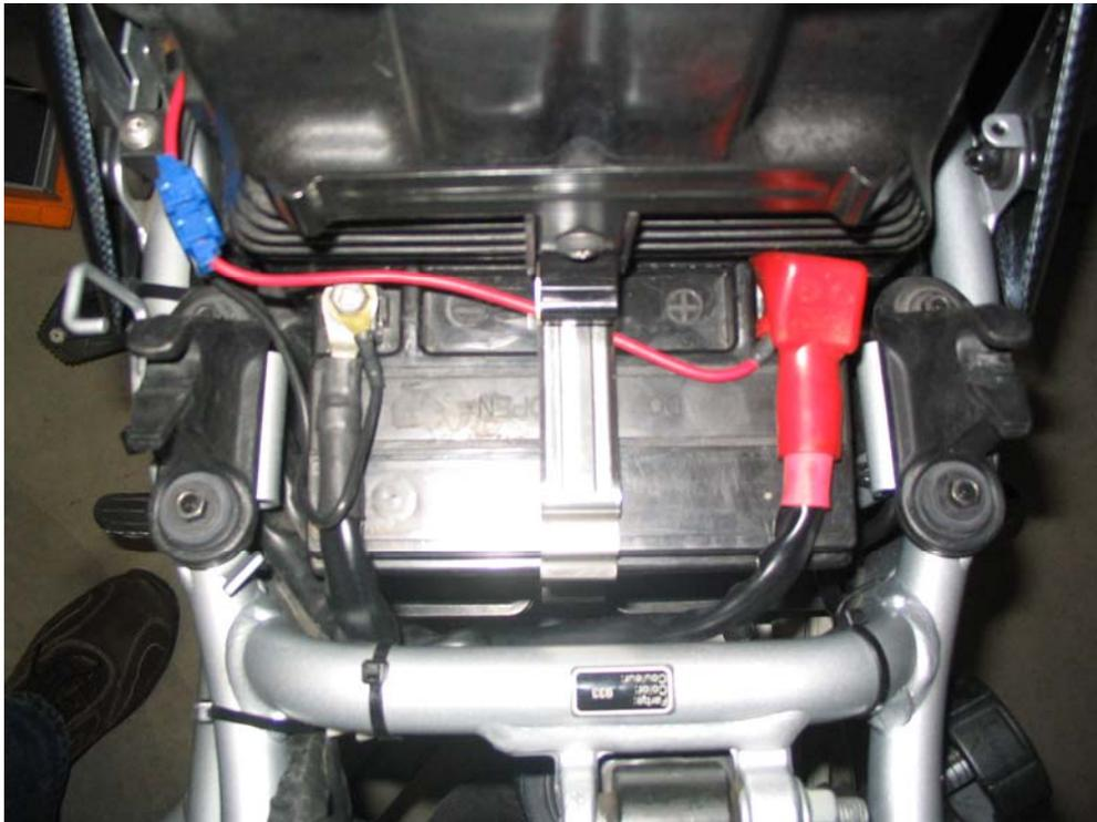
Dopo smontata la batteria originale provvedete a tagliare le due fascette che tengono i cavi del pos. e neg. uniti insieme...
