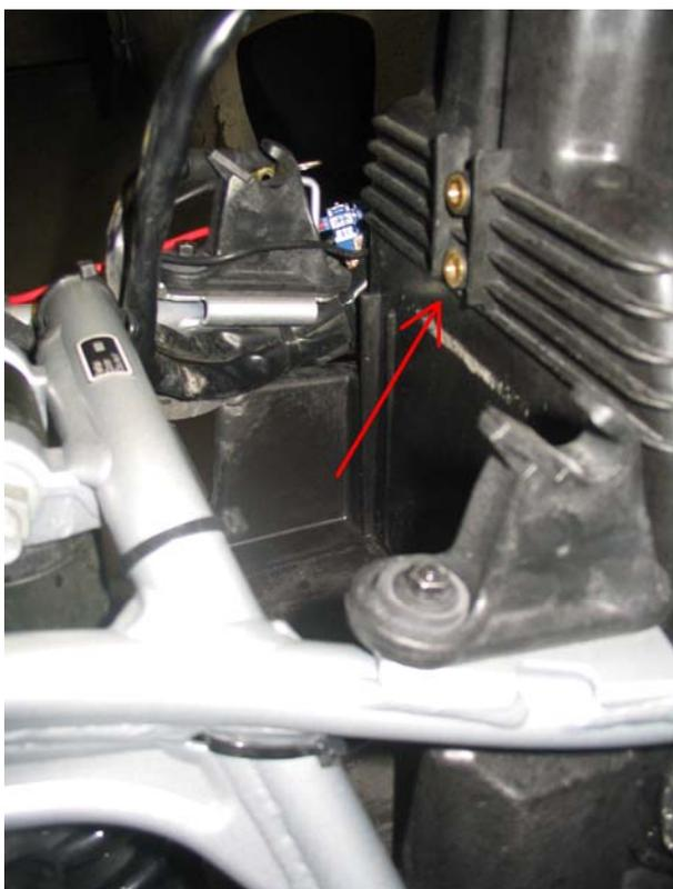
infine, dopo aver rifilato anche la placchetta di rame lato positivo e tagliato i noddolini di plastica... infilate la batteria nel suo alloggiamento.
